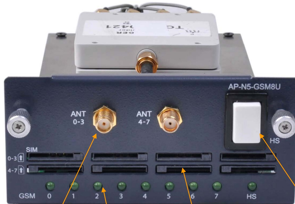
AP-N5-GSM8x (8-Port GSM Module)
